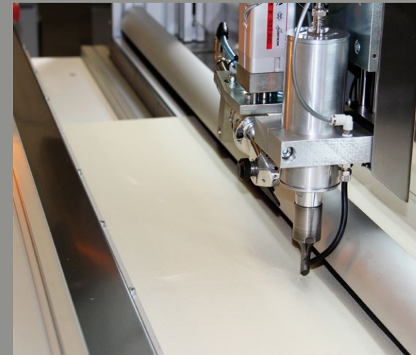
Automatic positioning of the longitudinal cutting tool / Colocación automática de la herramienta de corte longitudinal
