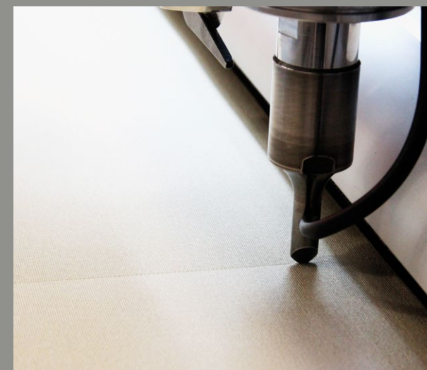
Ultrasonic head to cut and seal the edge simultaneously / Corte por ultrasonido para cortar y sellar el borde al mismo tiempo
