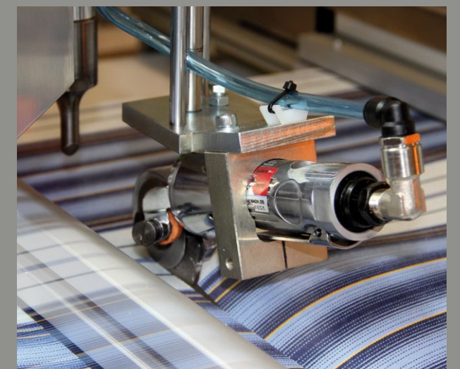
Rotary Blade for cross cutting (with ultrasonic optional) / Cuchilla rotativa para el corte transversal (con ultrasonido opcional)
